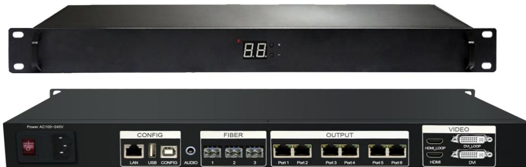
JZ-SEND06-HD 采用高速 USB 与 PC 通讯，并可用于多台发送器级联，操作更加简单方便。同时 JZ-SEND06-HD 还具备一系列丰富实用的功能，在生产测试、工程应用中有非常多优势。
